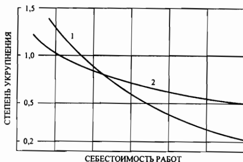
Рис. 1.4. График зависимости себестоимости монтажа от степени укрупнения (массы) элементов и количества монтажных циклов: 1 - при максимальной массе элементов до 10 т; 2 - то же, до 7 т
