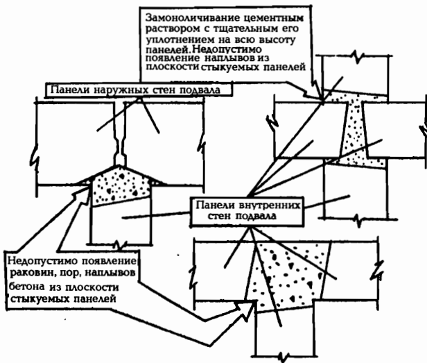
Рис. 5.15. Пооперационный контроль качества монтажа подземной части здания: а - монтаж элементов конструкций здания; б - замоноличивание стыков между панелями стен
