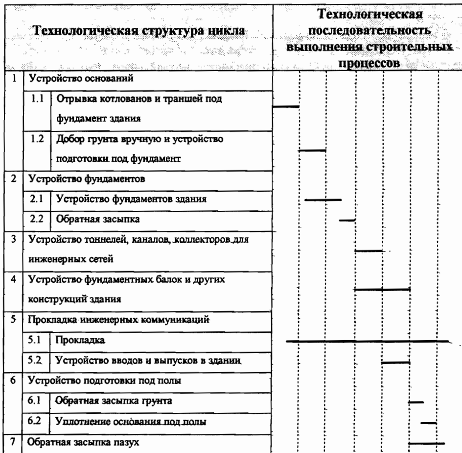
Рис. 2.9. Модель закрытой технологии возведения подземной части здания
